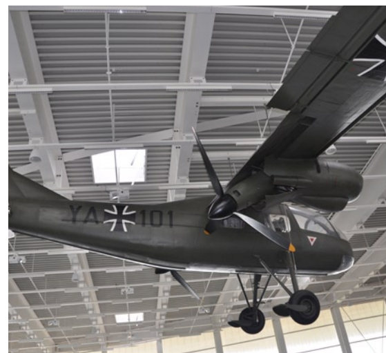
Die DO-29 mit Erstflug im Dezember 1958 war ein vom Verteidigungsministerium finanziertes Experimentalflugzeug für Kurz- und Senkrechtstart. Ein Serienbau war nie geplant. Die YA-101 ist das erste von drei gebauten Flugzeugen.
