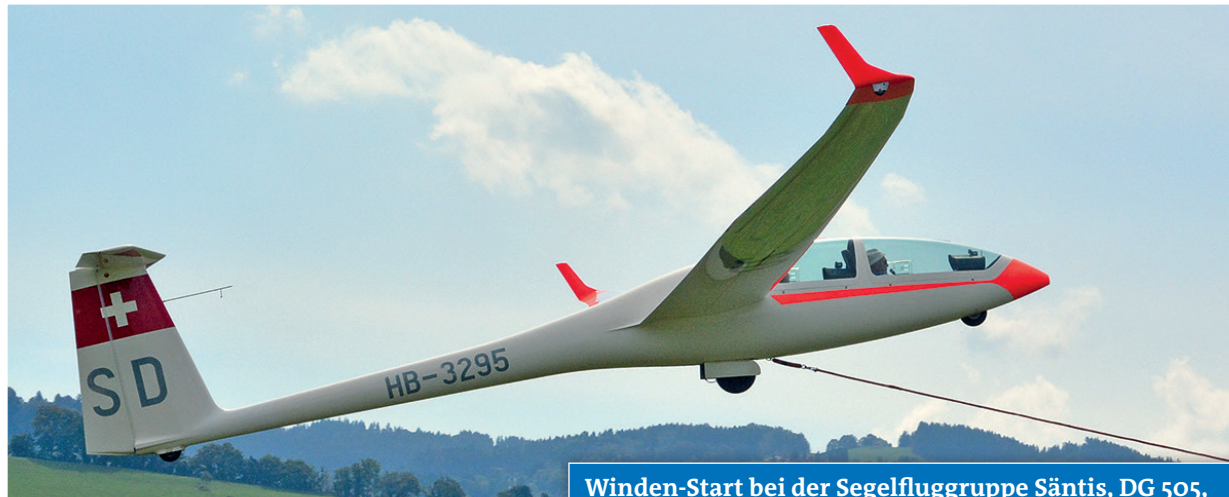
Winden-Start bei der Segelflugguppe Sântis, DG 505, Flügelspannweite 20 m, Höchstgeschwindigkeit 270 km/h Bild: Der Rheintaler
