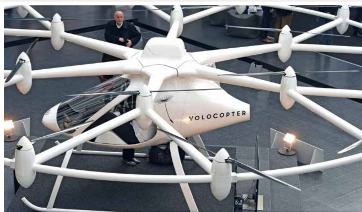
Prototyp des Volocopter VC200. Der Elektro-Helikopter mit insgesamt 18 Rotoren.
